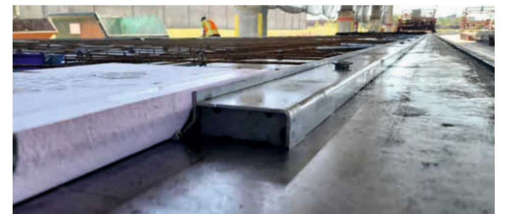
Los laterales para la producción de losas TT tienen una gran demanda en EE. UU.
