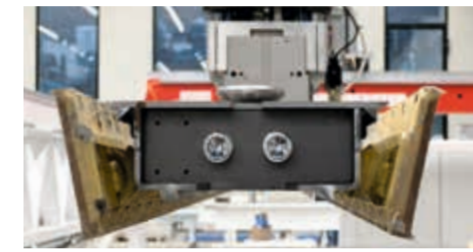
Encofrado retráctil para hormigonado a doble cara y manejo con robot
