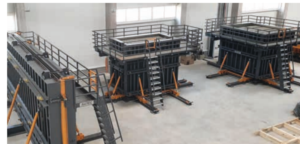
Vista de la fábrica con un molde de techo vertical y dos moldes modulares
