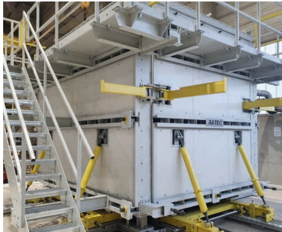
Molde con paneles sándwich en el encofrado exterior
