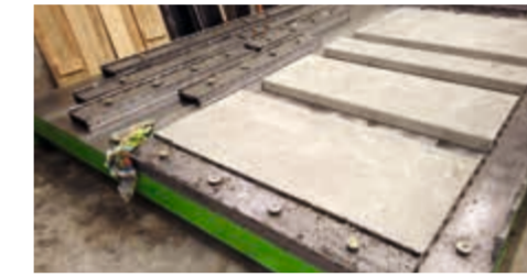
Encofrado retráctil para hormigonado a doble cara y manejo con robot
