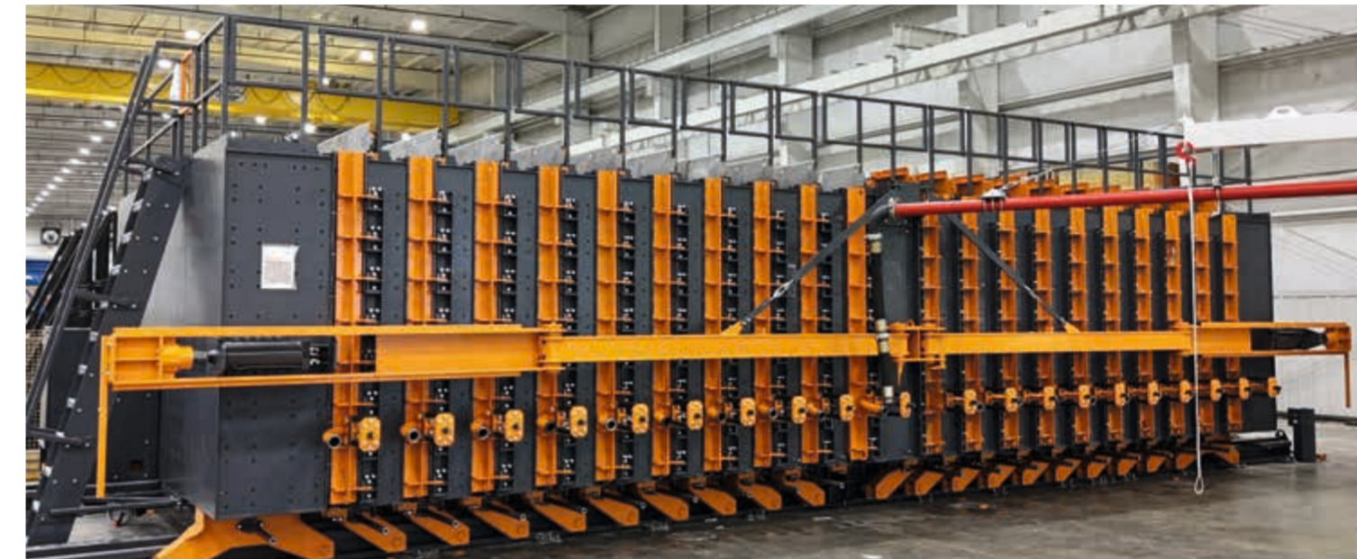
Con 2 x 10 bolsillos, este es el molde de batería más grande que RATEC ha instalado jamás
