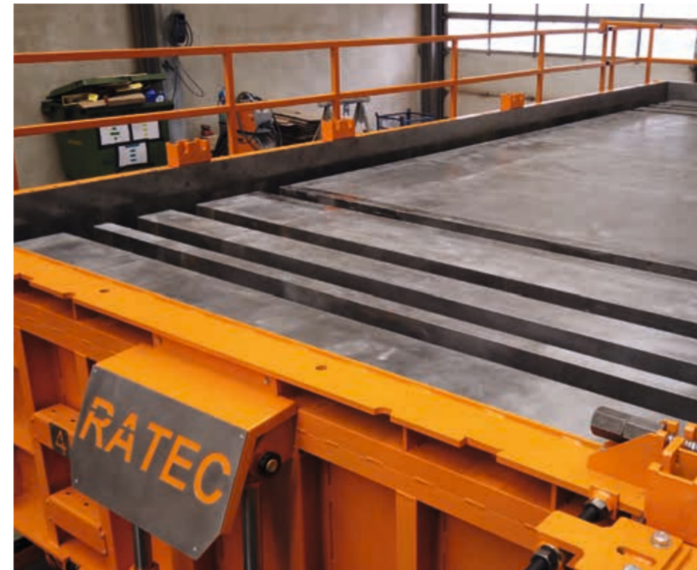
Molde de longitud regulable para bases de cables: ajuste flexible en incrementos de 20 cm
