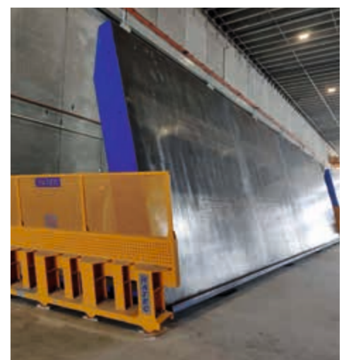
Mesa basculante hidráulica para elementos pretensados
