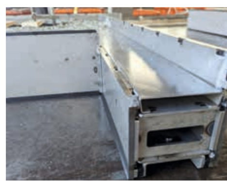
Gummilippen und Abdeckblech schützen vor Verunreinigungen
