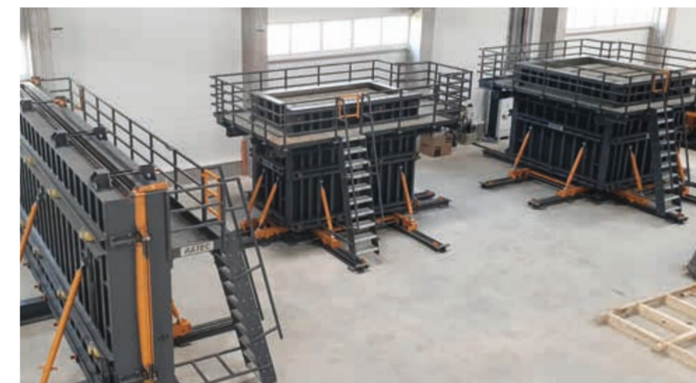
Blick ins Werk mit einer vertikalen Dachschalung und zwei Modulschalungen
