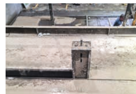
Seitlich verfahrbarer Innenabschaler für Batterieschalungen
