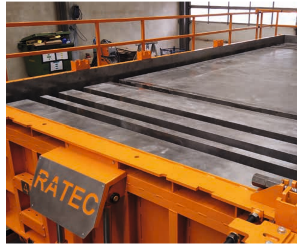
Längenverstellbare Schalung für Kabelkeller – flexibel im 20-cm-Raster anpassbar
