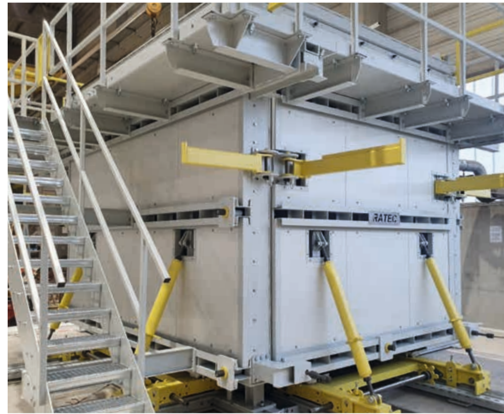
Schalung mit Sandwichpanelen an den Außentafeln
