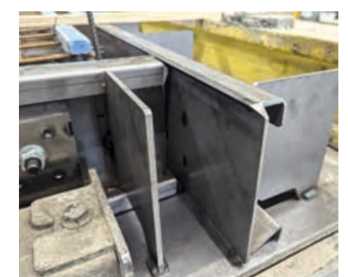
Die Stahlfront ermöglicht saubere Fasen
