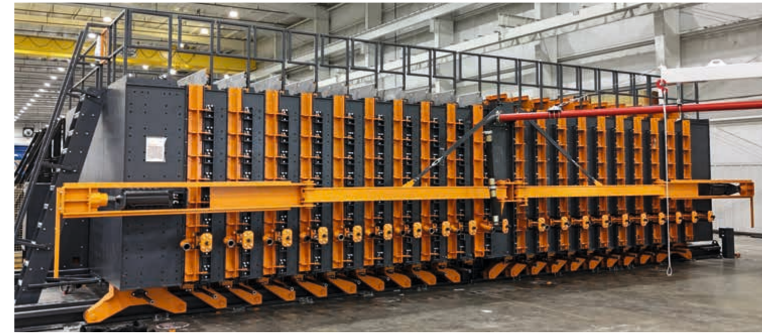
Mit 2 x 10 Taschen die größte Batterieschalung, die RATEC bisher installiert hat
