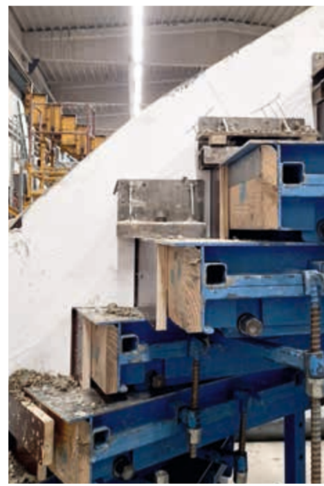
Der Treppenmagnet ist für die Schalungen gängiger Hersteller verwendbar
