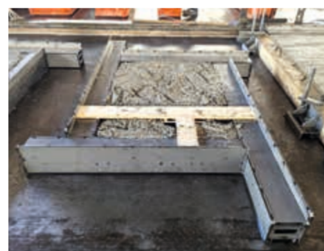
Beidseitig verwendbare Absteller mit unterschiedlichen Höhen
