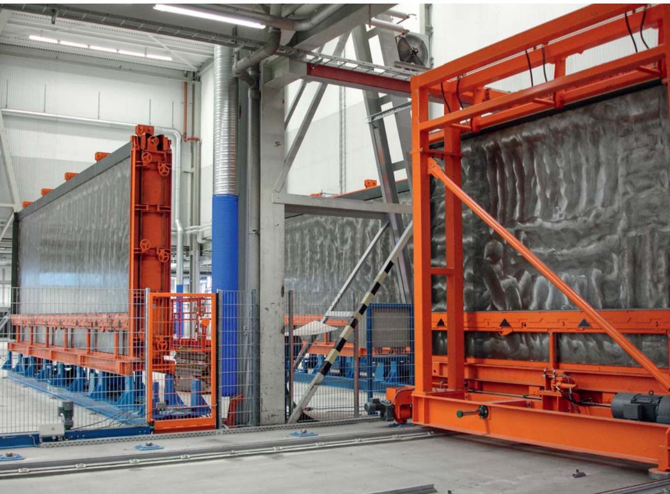
Planung einer Batteriefertigung: Arbeitsstationen mit verfahrbaren Innentafeln
