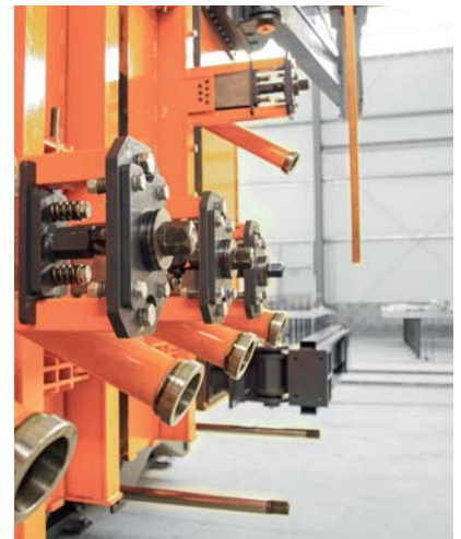
Füllanschluss zum Anschluss einer Pumpe für die Befüllung von unten
