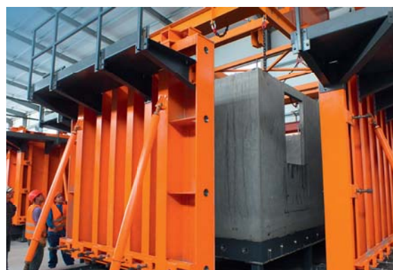
Für die Produktion in Einbaulage wird der 35 t schwere Schruppfkern in die Schalung gesetzt und zum Ausschalen herausgehoben
