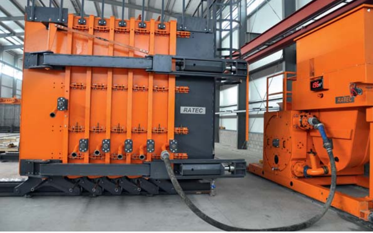
Batterieschalung mit verfahrbarer Pumplösung
