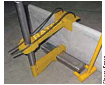
The Speedy Uniset is a standard adapter solution from Ratec Das Uniadapterset Speedy ist eine Standard-Adapterlösung von Ratec
