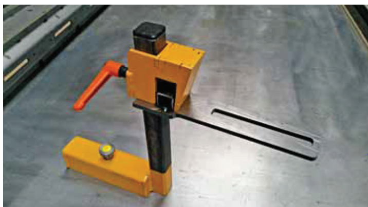
Add-on part for fixing embedded parts to the pallet Anbauteil zur Fixierung von Einbauteilen auf der Palette
