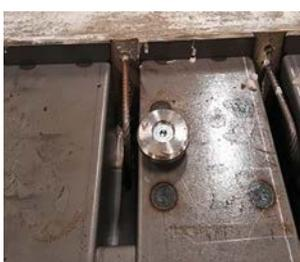
Encofrado con mecanismo desplazable dentado y orificio para armadura y prefabricado
