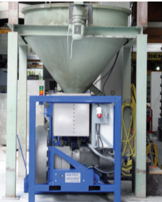
Anbindung der Betonpumpe, die von Ratec speziell für das upcrete System entwickelt wurde, inkl. Reinigungsoption im Betonfertigteilwerk
