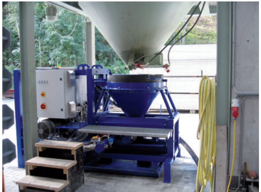
Anbindung der Betonpumpe, die von Ratec speziell für das upcrete System entwickelt wurde, inkl. Reinigungsoption im Betonfertigteilwerk
