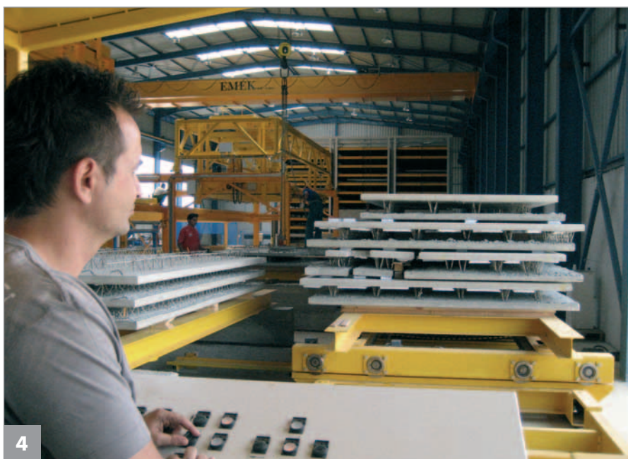
Die fertigen Elementdecken und Doppelwände werden montagegerecht für den Abtransport vorbereitet
