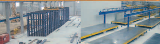
5 Füllung der Schalung von unten
