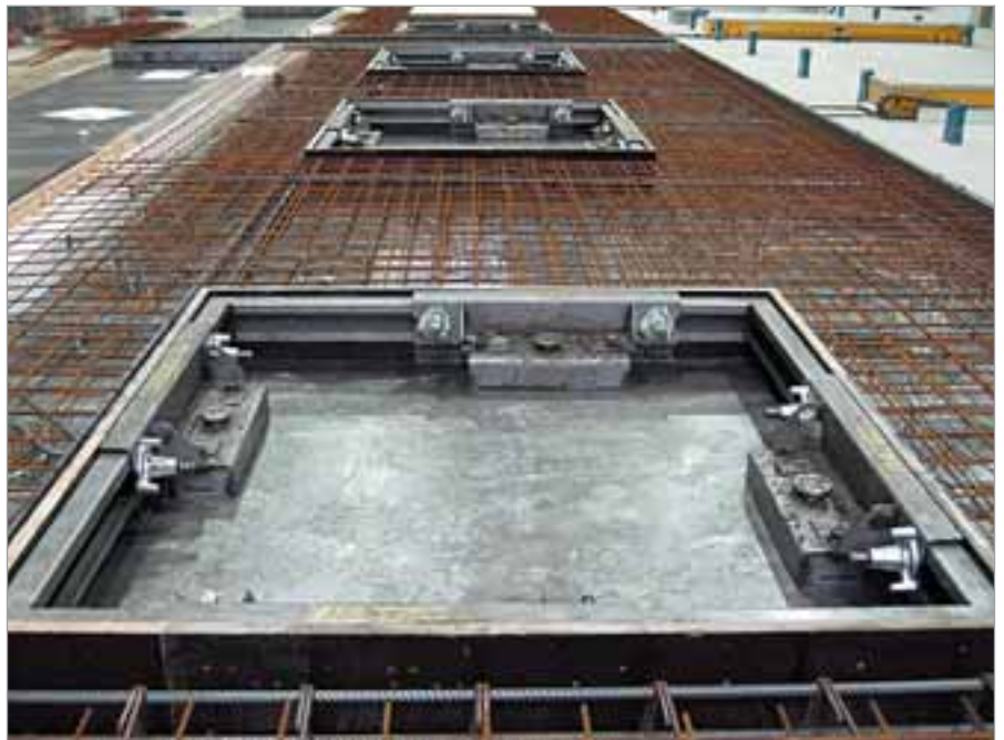
Anwendungsbeispiel für das PSV-System zur Fensteraussparung
