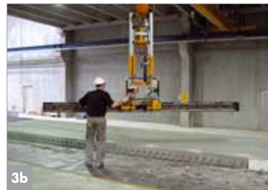
Schalungshandlingkran beim Entschalen
