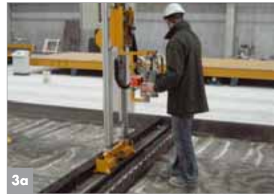
Schalungshandlingkran beim Einschalen
