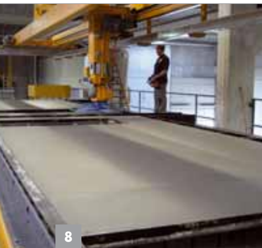
Glätten der Betonoberfläche mit funkgesteuerter Glätteinrichtung
