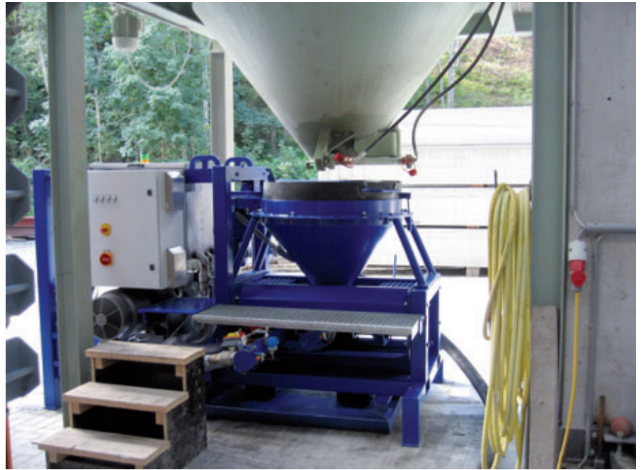
Collegamento della pompa del calcestruzzo sviluppata appositamente da Ratec per il sistema upcrete, inclusa opzione di pulizia, presso la centrale di prefabbricazione
