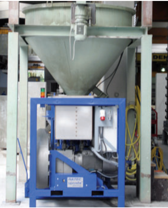
Collegamento della pompa del calcestruzzo sviluppata appositamente da Ratec per il sistema upcrete, inclusa opzione di pulizia, presso la centrale di prefabbricazione
