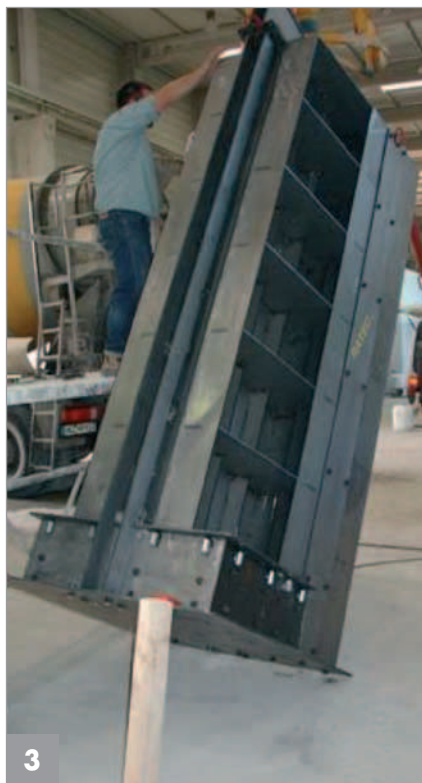
Cassaforma ribaltata, riempimento dall'alto
