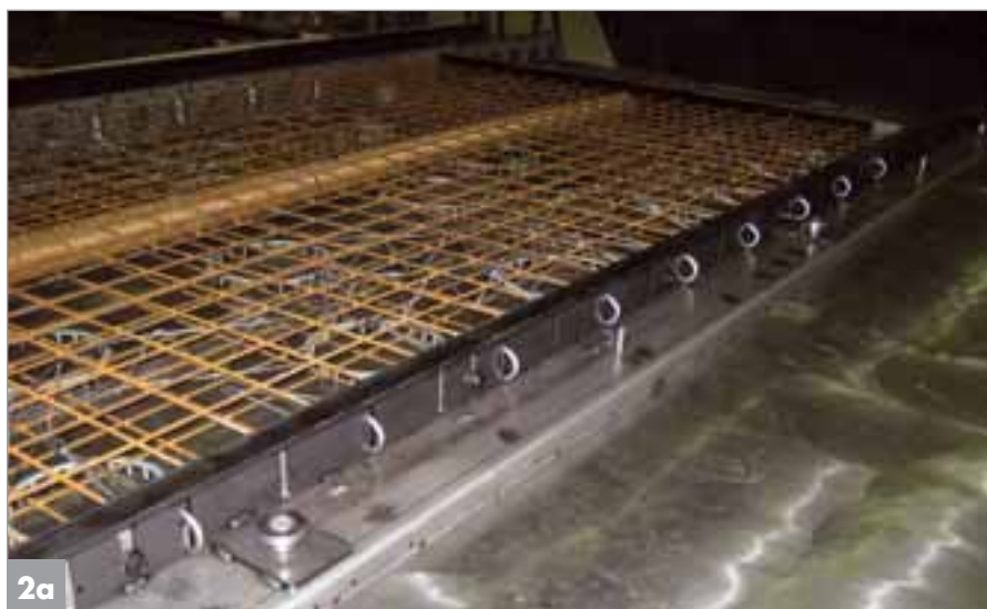
Sistema di casseforme flessibile con armatura di collegamento
