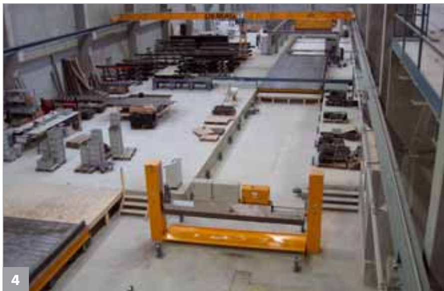
Stazione di cassetatura con magazzino di casseforme
