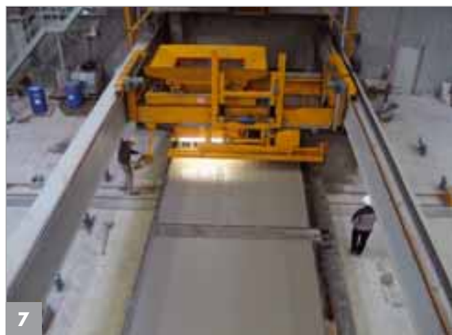
Distributore di calcestruzzo con staggia tandem
