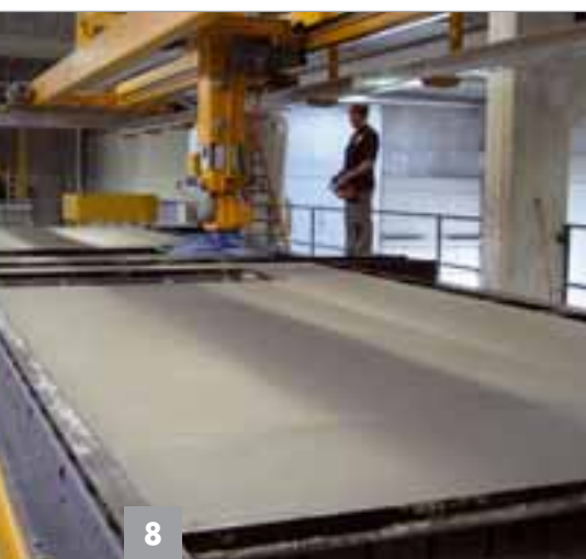
Lisciatura della superficie in calcestruzzo con dispositivo di spianamento radiocomandato
