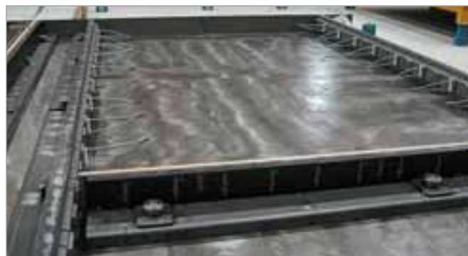
SAS_MF con modulo applicato in legno o acciaio nei fermagetti longitudinali e trasversali
