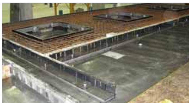
SAS_MF con modulo applicato in legno o acciaio nei fermagetti longitudinali e trasversali
