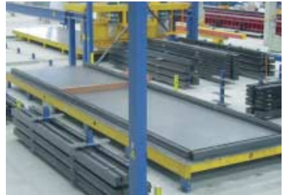
Estación el encofrado y desencofrado con almacén de encofrado y limpieza Shuttering and stripping station, with mold storage and cleaning facilities
