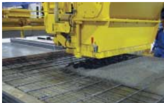
Distribuidor de sinfines de hormigón con compuerta hidráulica de limpieza Worm-type concrete distributor with hydraulic cleaning gate
