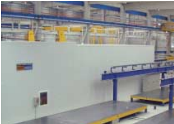
Cámara de secado con revestimiento y compartimentos de estantes de 2x15 Curing chamber with cladding and 2 x15 racks
