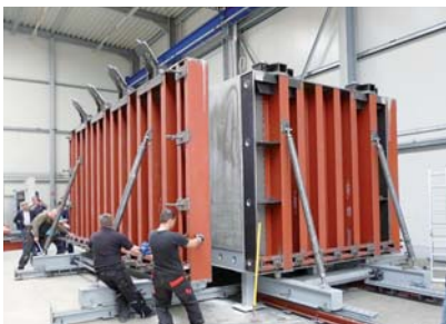
Öffnen der Modulschalung
