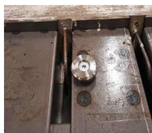
Schalung mit Schubverzahnung und Bewehrungsdurchdringung und fertiges Element
