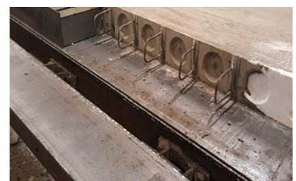
Schalung mit Schubverzahnung und Bewehrungsdurchdringung und fertiges Element
