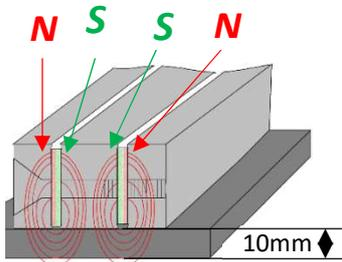
Das Magnetfeld der Ratec Magnete wirkt bis ca. 10 mm
