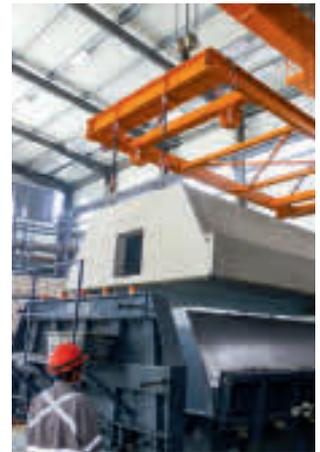
Beispiel: Dachschalung für upcrete®, für die Befüllung von unten
