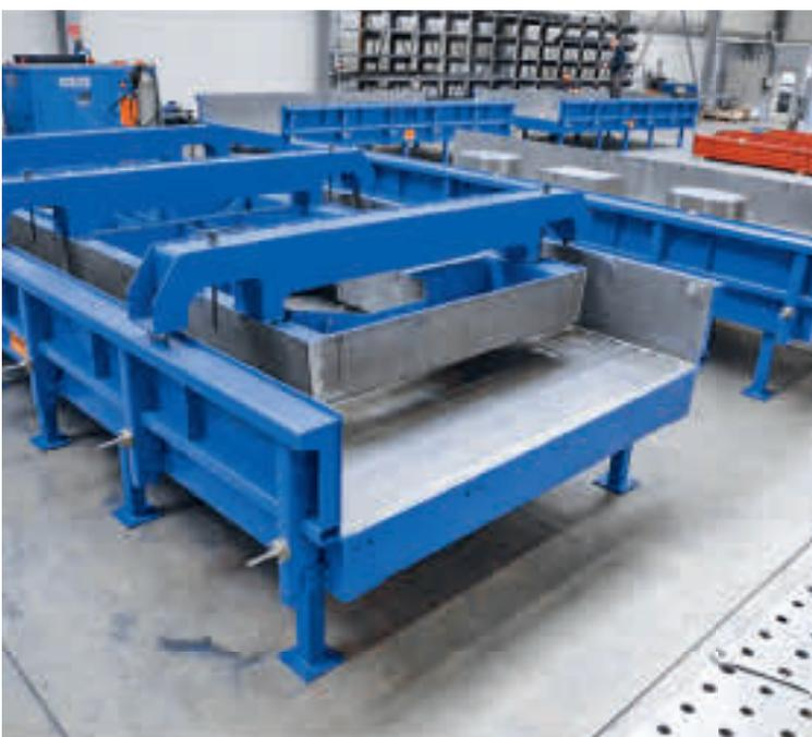
Die Betonelemente für die Standseilbahn sollten mit herausstehender Bewehrung produziert werden. Die Schalung wurde so entworfen, dass die Tische auch nach dem „Spezialeinsatz“ für die Produktion anderer Elemente weiterverwendet werden können.
