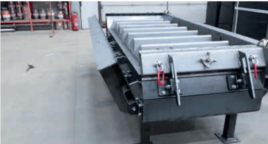
Sonderlösung für eine Treppenschalung. Drei dieser Treppenformen wurden in eine Umlaufpalette eingepasst und gehen so in den regulären Umlauf im Werk.
